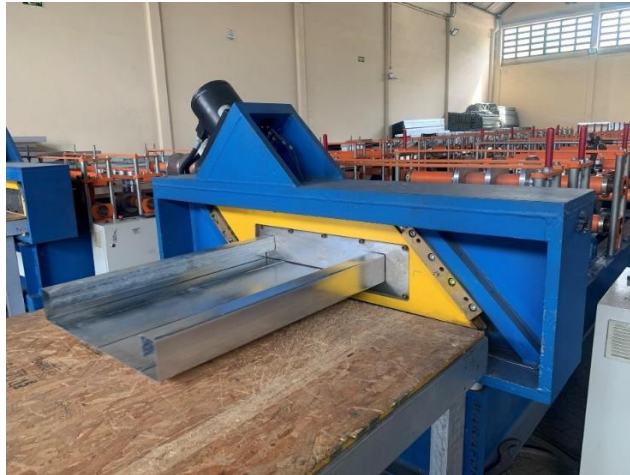
Figura 14 – Fabricação do módulo metálico do Sistema Steel Panel Quick House
